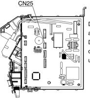
Der CN25 des RAC-35YHA6 ist auf dem linken Bild zu sehen. Die Platzierung auf der Platine des CN25 ist ie nach Modell
